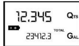
Se si continua ad utilizzare il contalitri senza sostituire le batterie, si giungerà al secondo livello di allarme batteria che inibisce il funzionamento. In questa condizione l'icona di batteria diventa lampeggiante e rimane l'unica visibile sull'LCD
